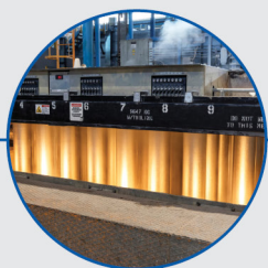
Làm lạnh đột ngột khi đổ qua khuôn Rapidly cool down while pouring into mandrel
