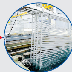
Xử lý nhiệt để đạt độ cứng cần thiết Tempering in aging furnace
