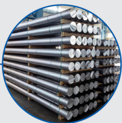
Billet dài 6.3m sau khi cắt bỏ phần thừa ở 2 đầu Cut off the waste ends to 6.3m
